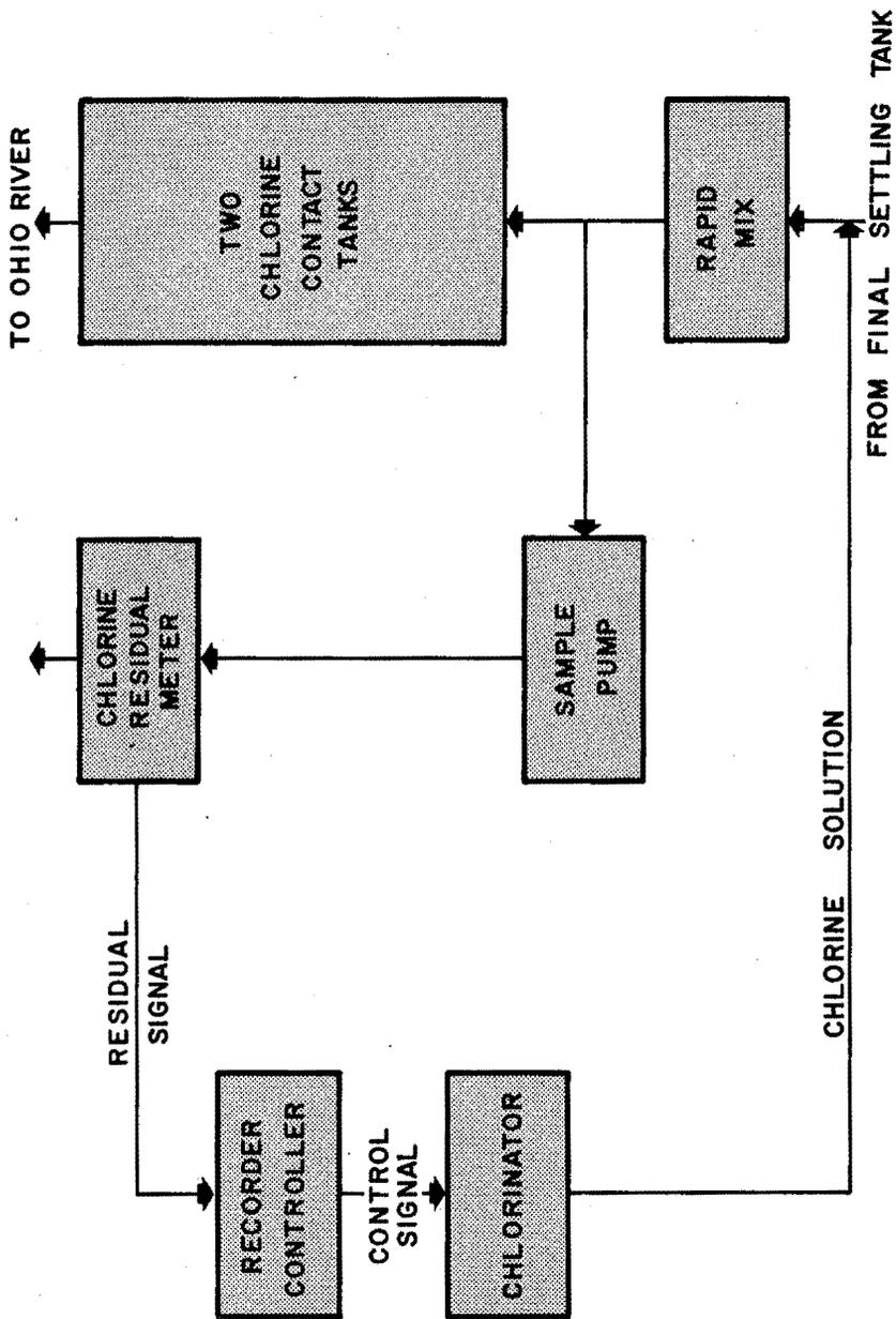
Fig. 8 — Effluent chlorination control.
